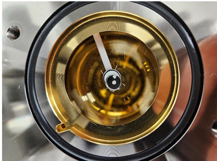
*Ofenraum mit kleiner Glasprobe im Platintiegel.*
