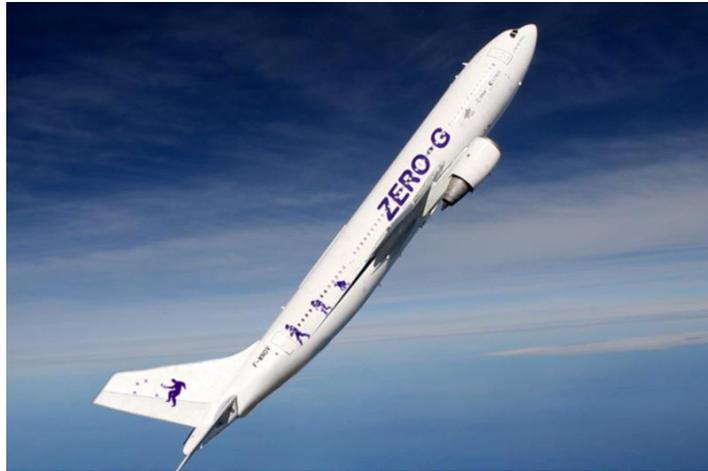
Bei einem Parabelflug wird die Schwerelosigkeit simuliert – dies wird zum Beispiel für wissenschaftliche Zwecke in der Forschung genutzt. Foto: DLR/Novespace
