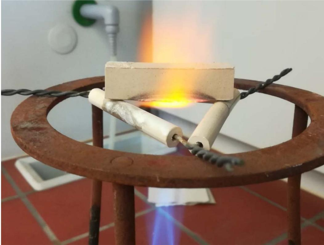
*Brandschutztest am INW, ca. 1150°C für 15 min. ohne Schädigung*
