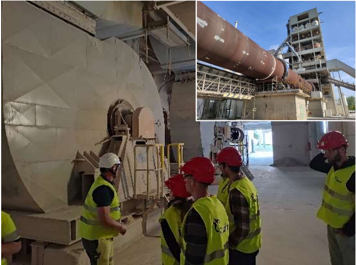
Studierende vor den Gebläsen für Materialtransport und Abgasführung sowie Drehrohrföfen und Wärmetauscherturm (oben rechts).
