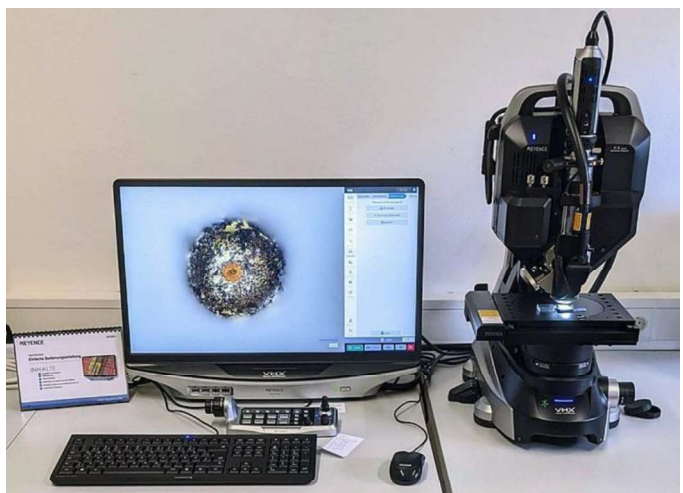
Digitalmikroskop mit LIBS-Analyseeinheit
